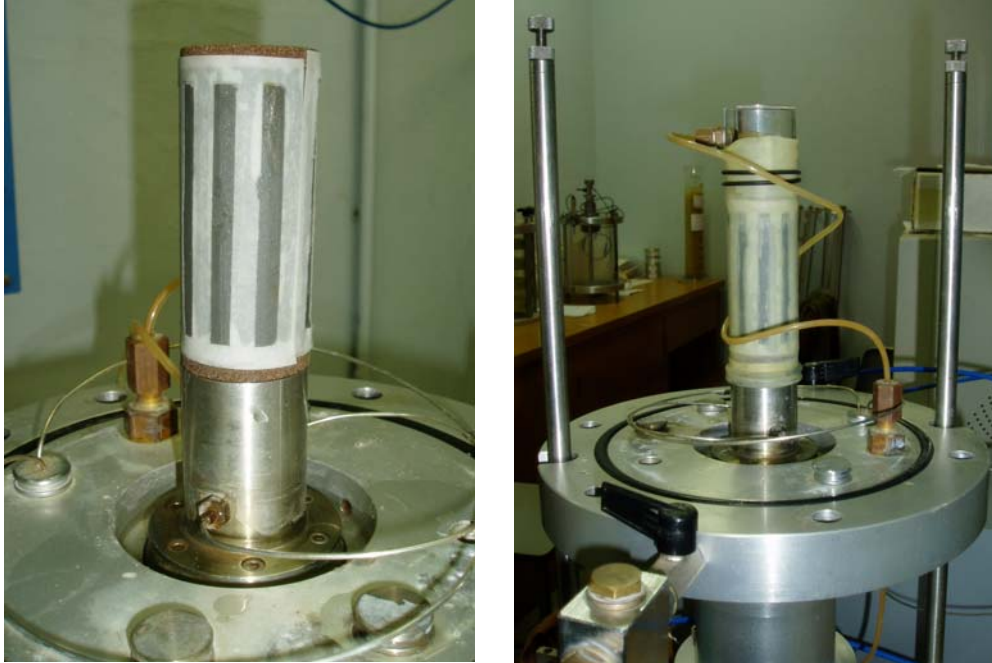
Figura 5.7 - Montagem do corpo de prova na prensa triaxial
