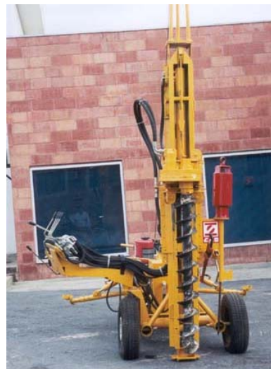
Figura 4.3 - Fotos da máquina perfuratriz de trado oco
