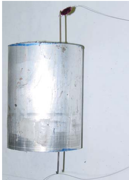
(a) Inserção da corda de violão no shelby com o auxílio de uma agulha
