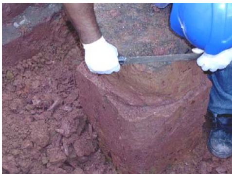
(b) Corte e moldagem do bloco
