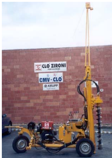
Figura 4.3 - Fotos da máquina perfuratriz de trado oco
