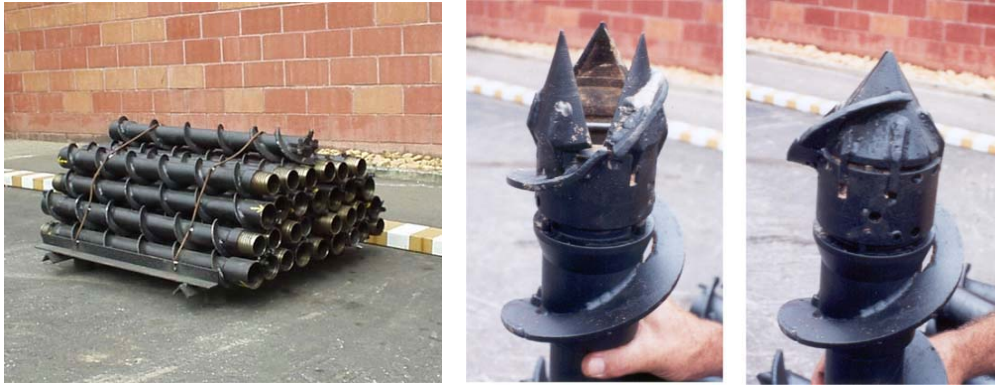
Figura 4.4 – Segmentos de trados ocios da perfuratriz e ponteira com abertura.
