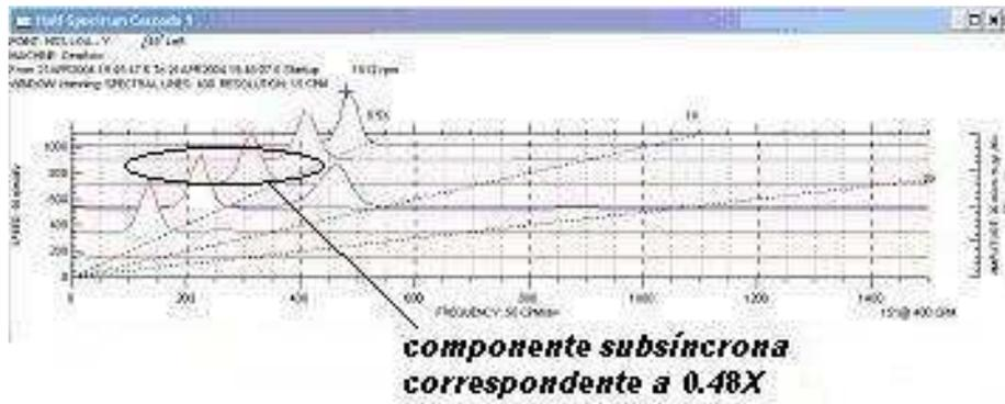
Figura 3.27: Espectro de vibração durante a partida
