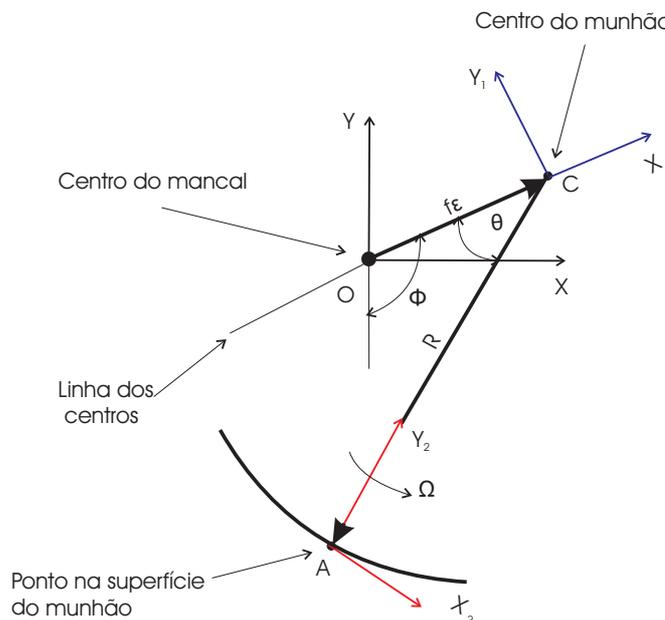
Figura 3.9: Cinemática para definição de  $U$  e  $V$
