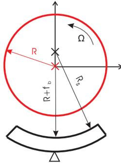
Figura 3.31: Precarga de um mancal de sapatas oscilantes
