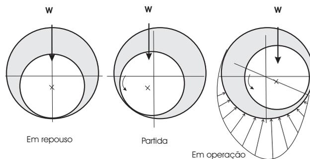
Figura 3.5: Funcionamento do mancal radial
