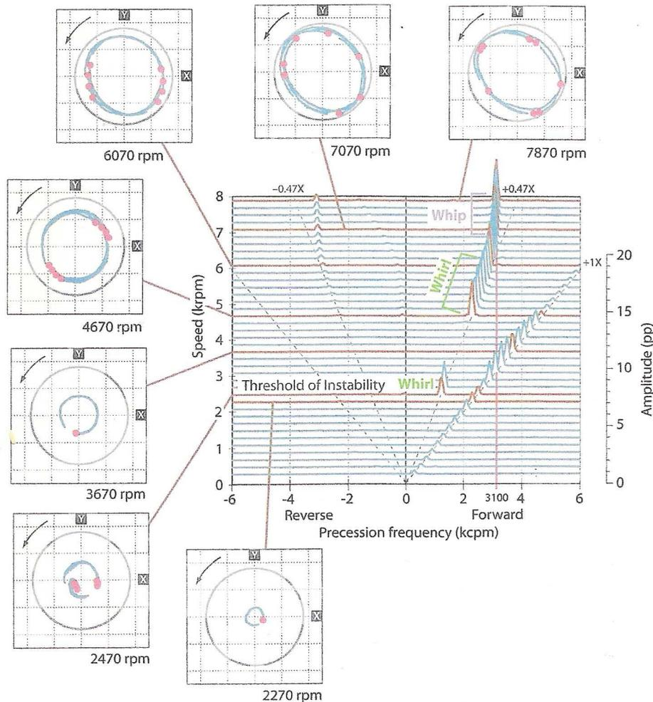
Figura 3.24: Espectro em cascata de vibração de um rotor experimental
