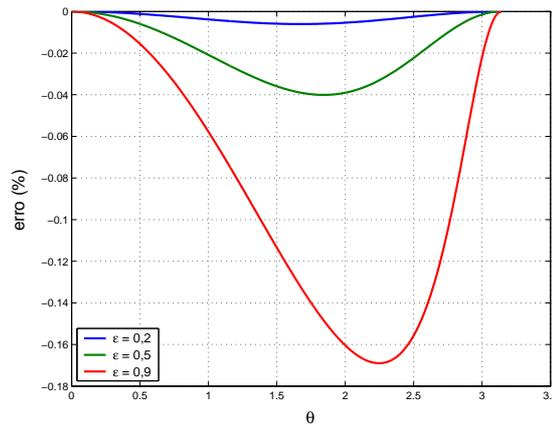
Figura 3.7: Erro da aproximação da espessura do filme
