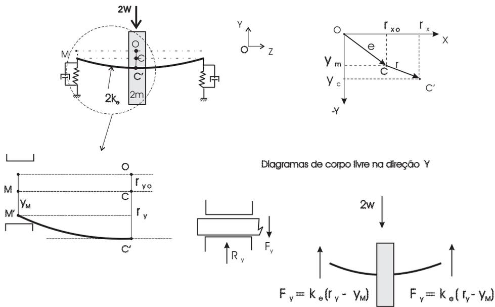
Figura 3.22: Rotor de Jeffcott em mancal hidrodinâmico
