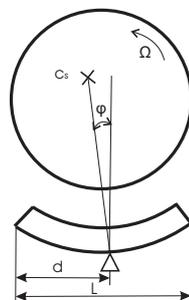
Figura 3.30: Oscilação da sapata e “offset” de um mancal
