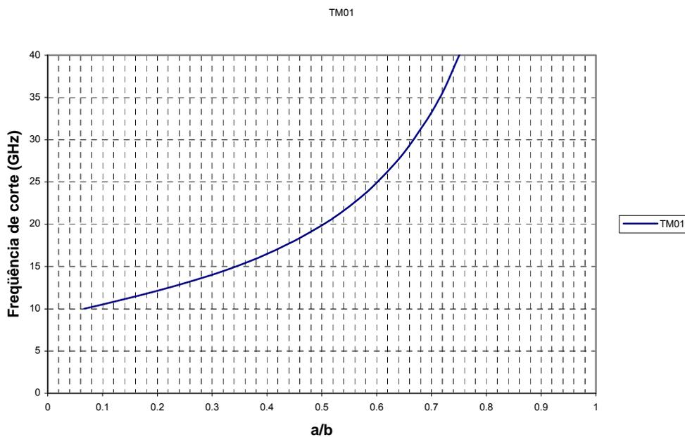
Figura 2.3 - Frequência de corte para o modo  $TM_{01}$  fixando b em 15 mm
