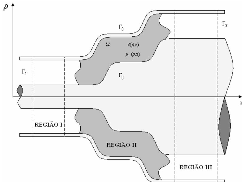
Figura 2.1 - Guia coaxial de simetria cilíndrica.
