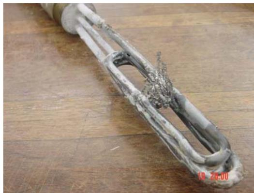
Figura 4.82 – Cartucho de resistência danificado (2)
