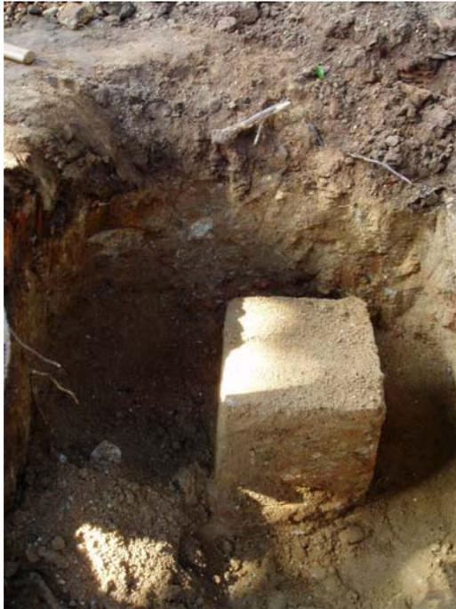
Figura 4.44 – Bloco de solo moldado
