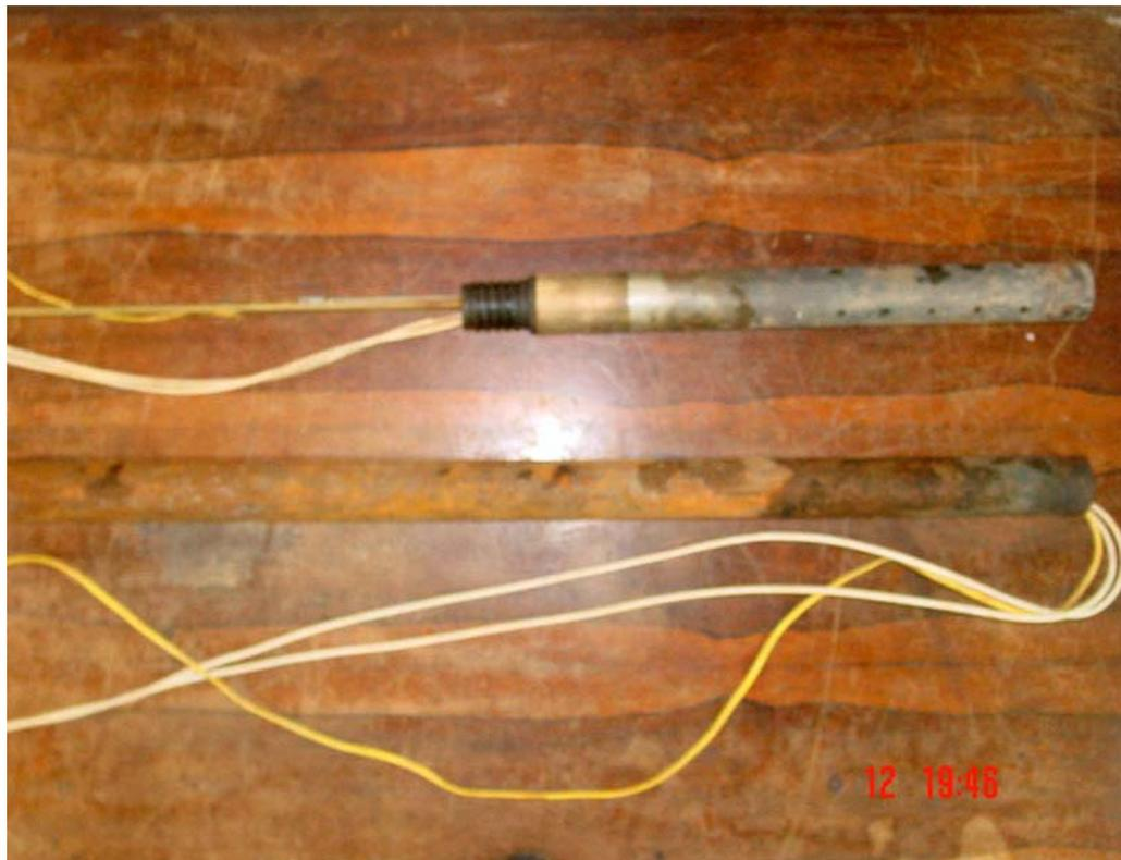
Figura 4.80 – Elementos estruturais do bastonete térmico
