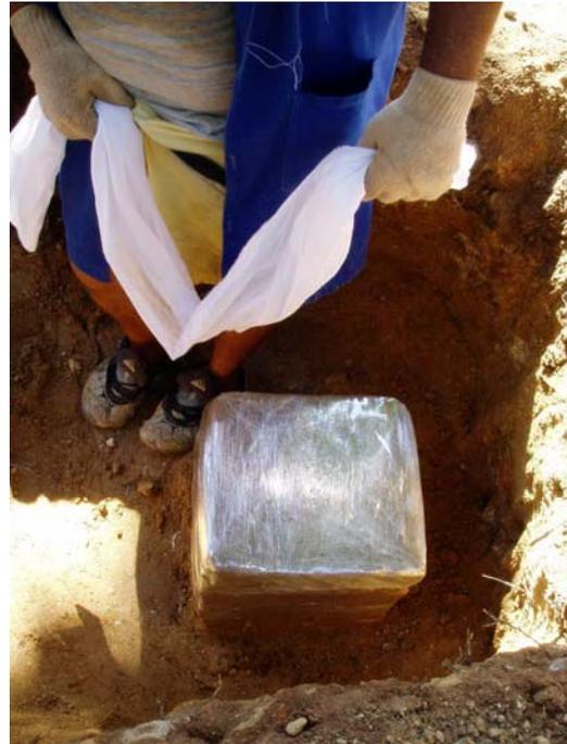
Figura 4.45 – Isolamento do bloco
