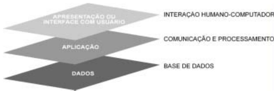
Figura 51 – Modelo em três camadas de software
