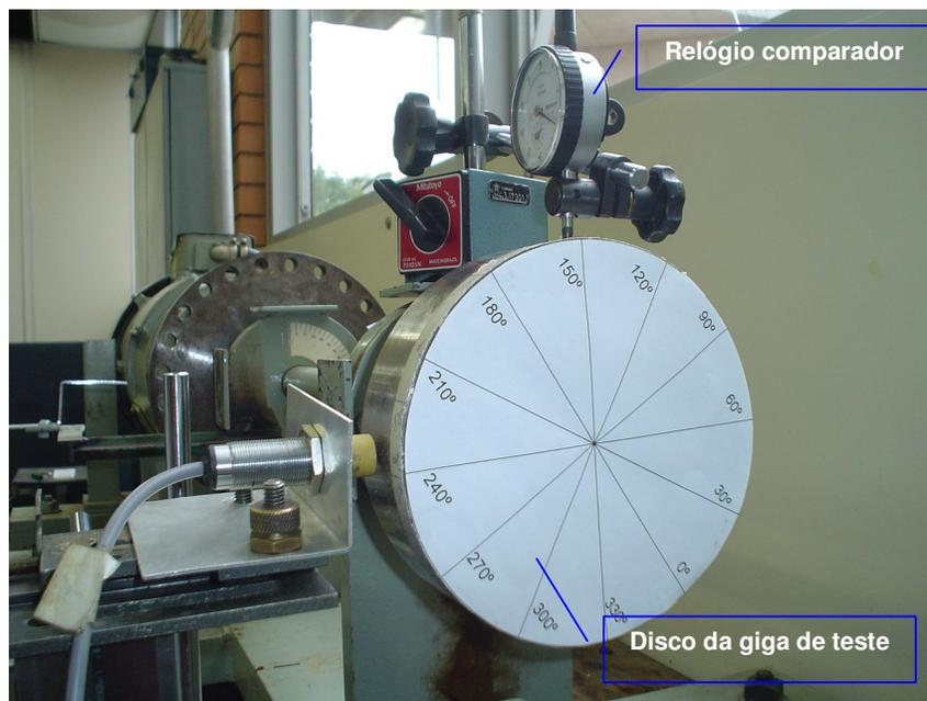
Figura 15 - Calibração estática da giga de teste
