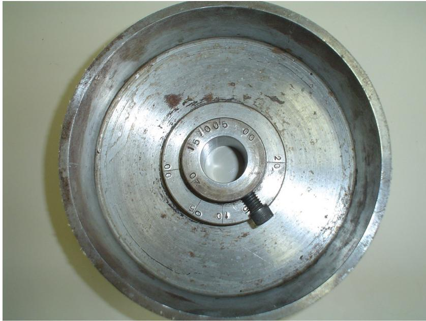
Figura 14 - Detalhe do ajuste da excentricidade do disco
