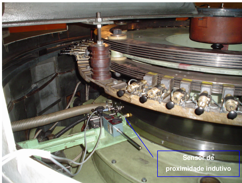
Figura 8 - Montagem do sensor indutivo para medição da oscilação
