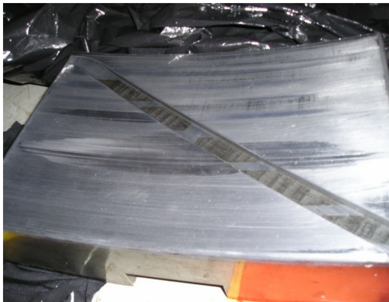
Figura 2 - Sapata do mancal queimada
