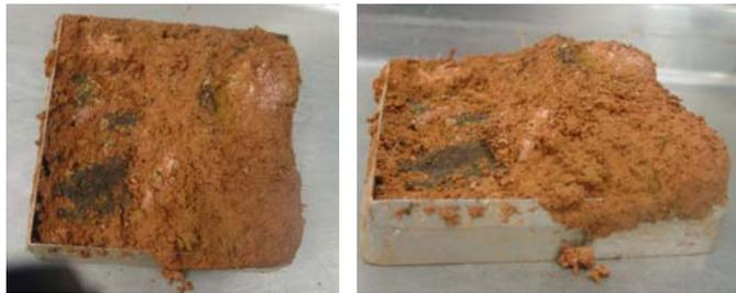
Figura 4.5 – Corpo de prova descartado devido à “quebra” deste na interface concreção-matriz
