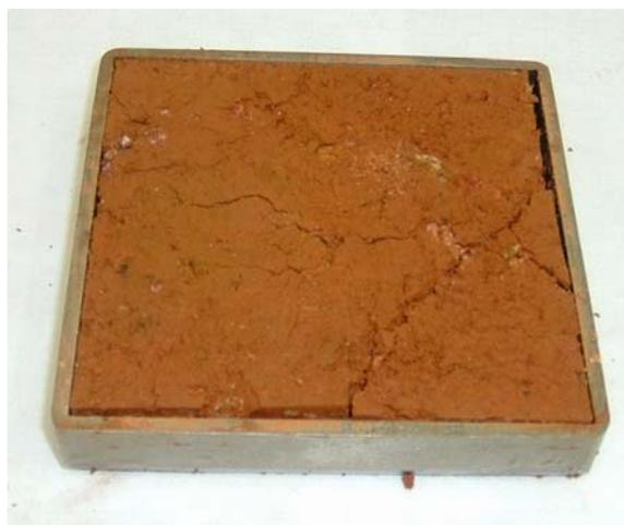
Figura 4.6 – Corpo de prova do solo coluvionar após ser seco à vácuo
