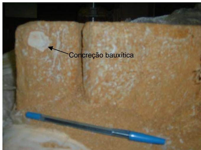
Figura 3.5 – Concreção bauxítica presente na amostra indeformada do solo residual jovem
