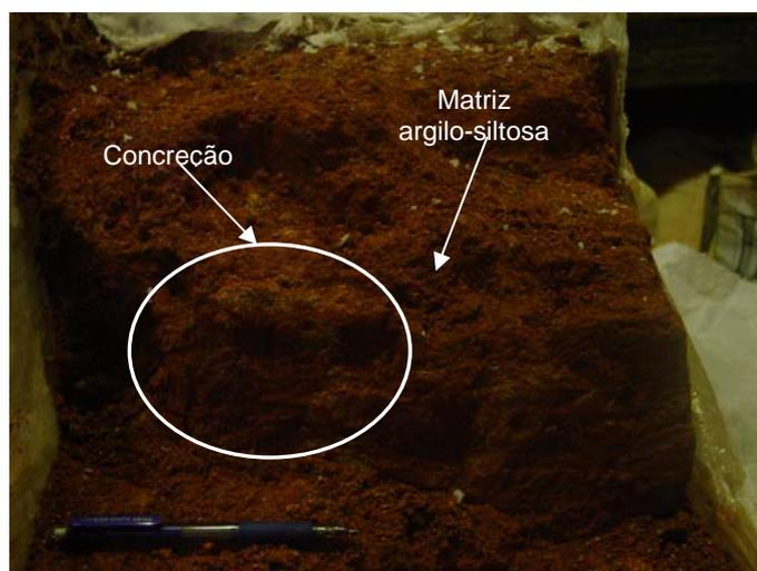
Figura 3.6 – Foto da amostra do solo coluvionar indicando os elementos que o compõe
