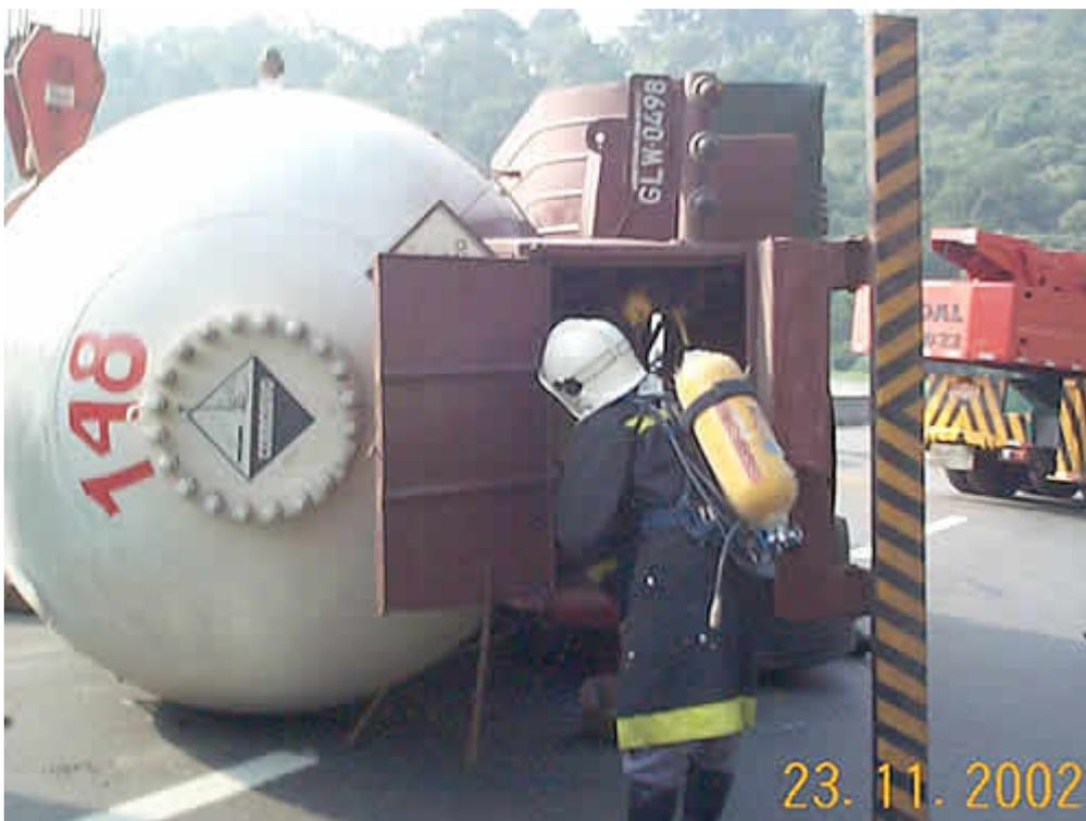
Figura 3-3 - Bombeiro examina caixa de válvulas de carreta acidentada (Fonte: CETESB – 2005)
