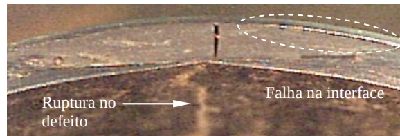
Figura 5.13 - Ruptura do espécime de uma camada.
