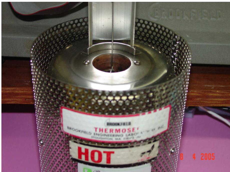
Figura 2.5: Thermosel: copo com aquecimento
