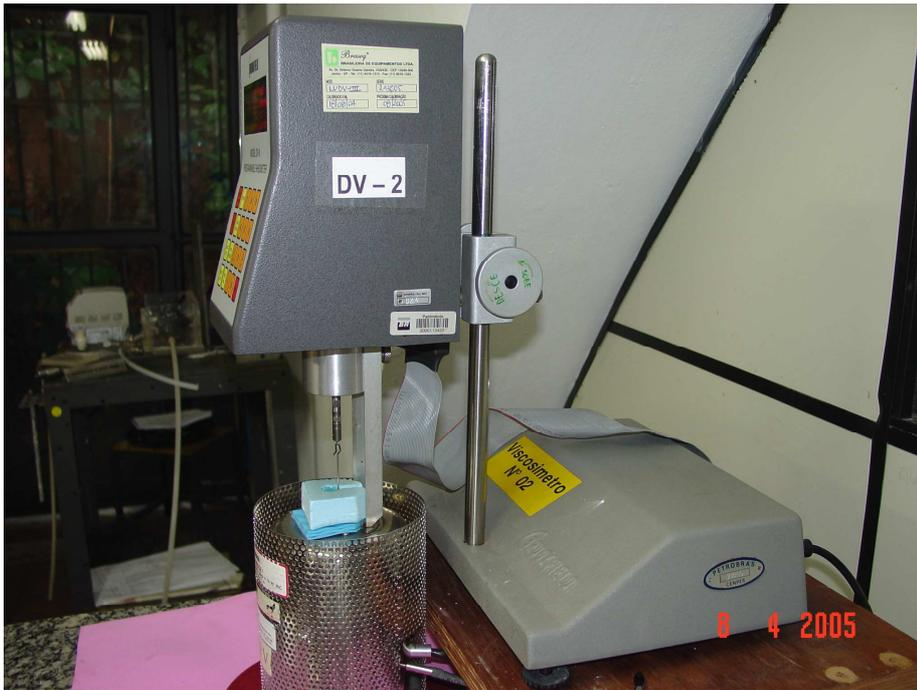
Figura 2.7: Thermosel: tampa de silicone
