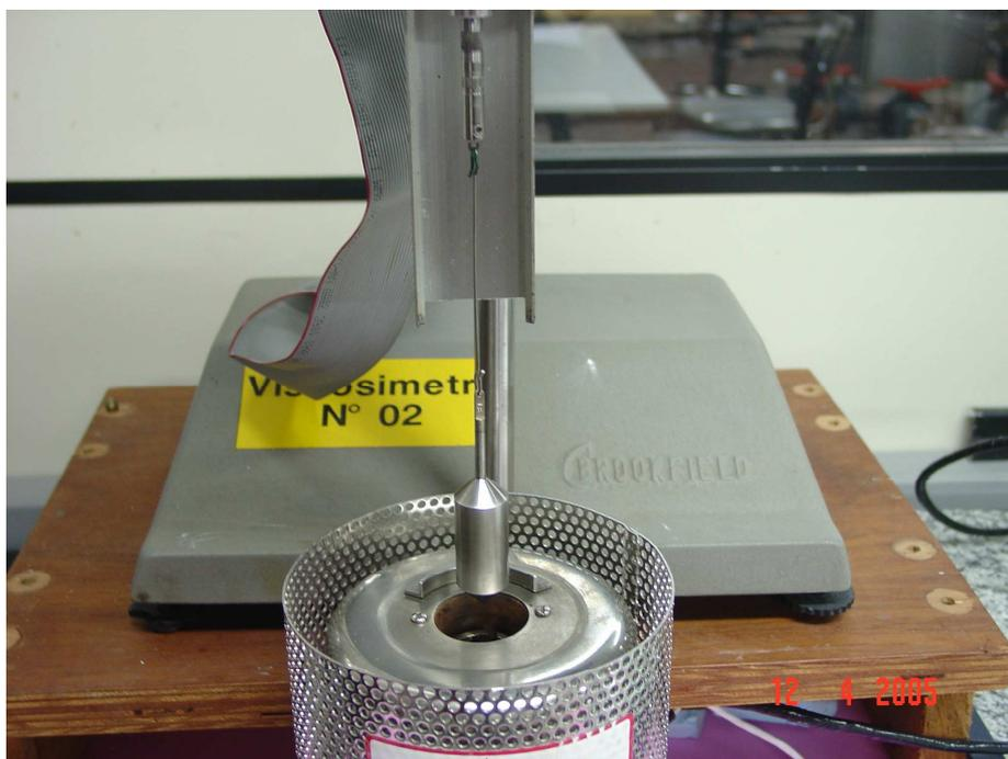
Figura 2.6: Thermosel: cilindro suspenso
