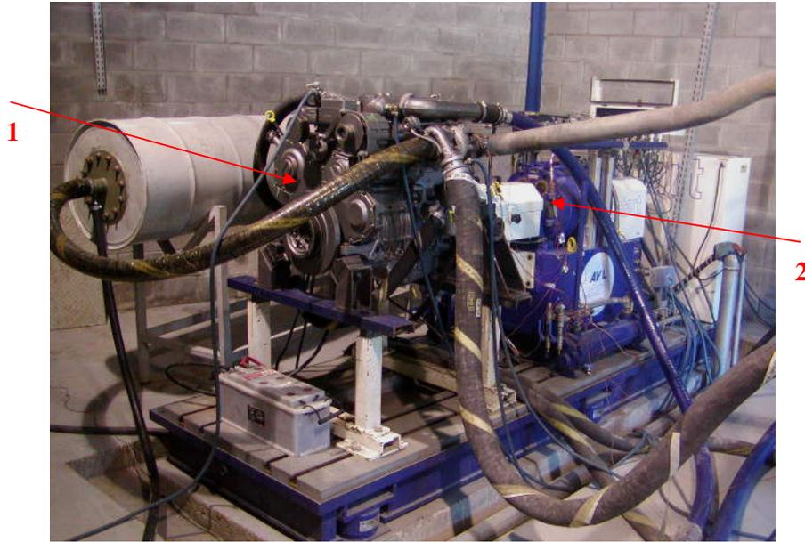
Figura 20 – Montagem do motor na bancada do dinamômetro
