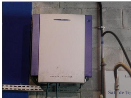
Figura 11 – Balança do combustível diesel.
