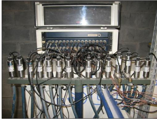
Figura 14 – Arranjo dos transdutores de pressão.
