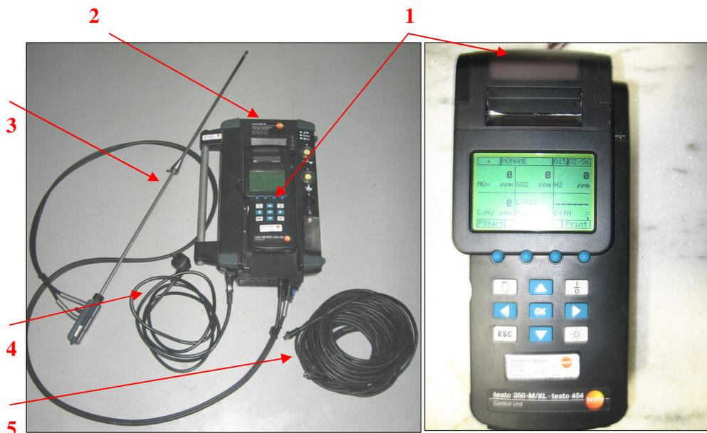
Figura 17 – Equipamento de medição de emissões Testo.
