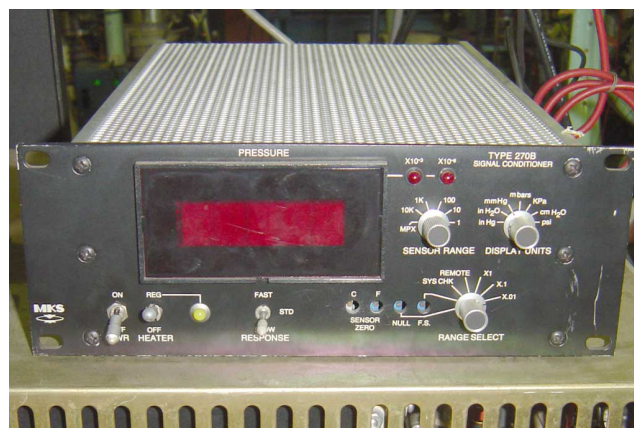
Figura 2.5: Foto frontal do manômetro capacitivo absoluto, MKS Baratron, modelo 270B-4.
