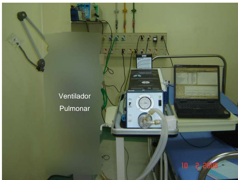
Figura 17 - Montagem para a aquisição dos dados durante. Foto do simulador, laptop, e ventilador.
