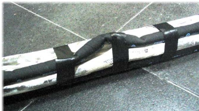
Figura 81: Flambagem de um dos músculos devido à pressão interna muito baixa
