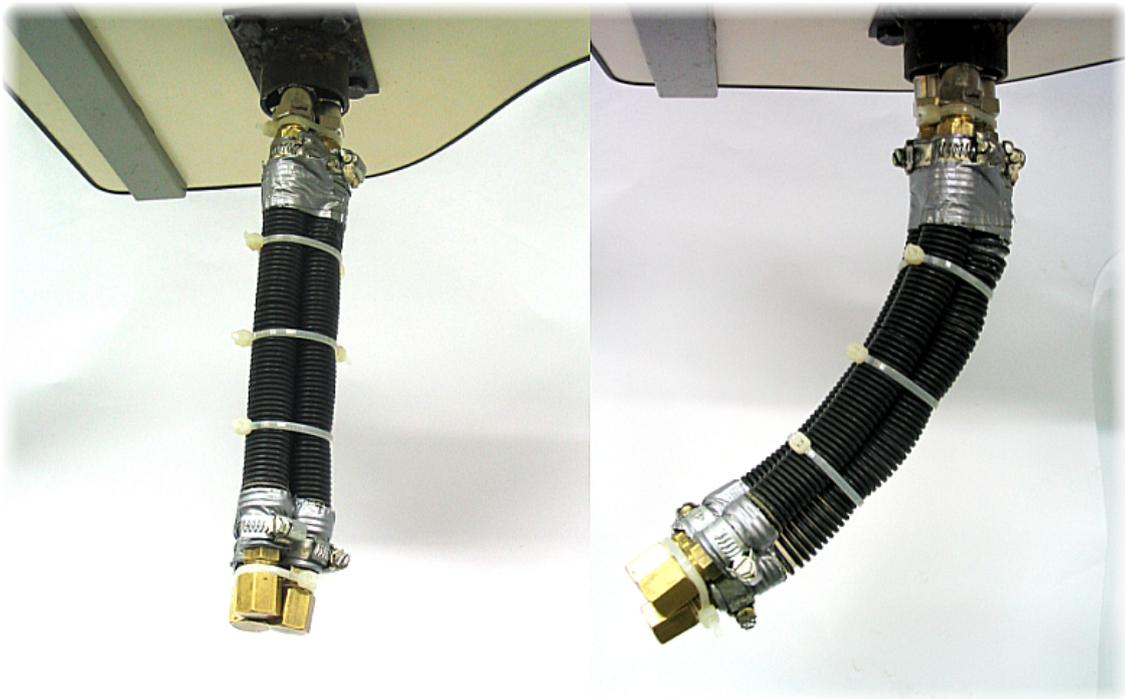
Figura 69: 4ª Geração, mangueiras de silicone reforçadas com anéis flexíveis de butadieno-acrilonitrila, agrupadas com abraçadeiras
