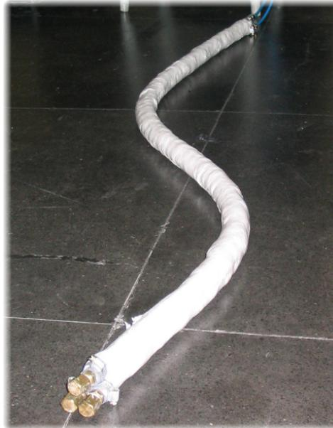
Figura 64: 2ª Geração, mangueiras de silicone revestidas com cola de poliuretano
