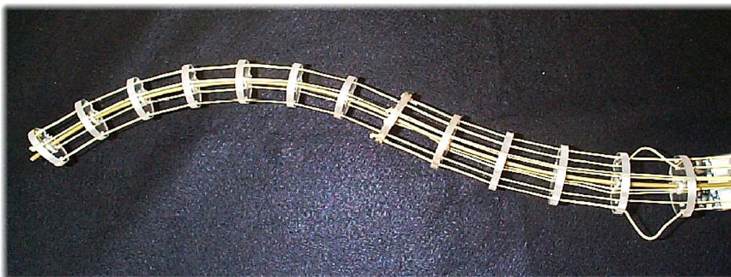
Figura 5: Robô contínuo tipo tentáculo
