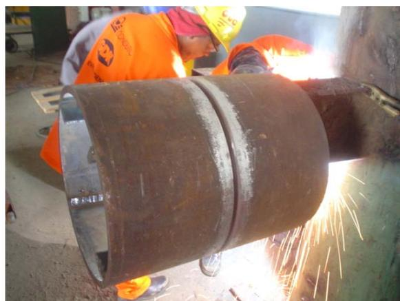
Figura 17– Fixação do anel na posição horizontal fixa.
