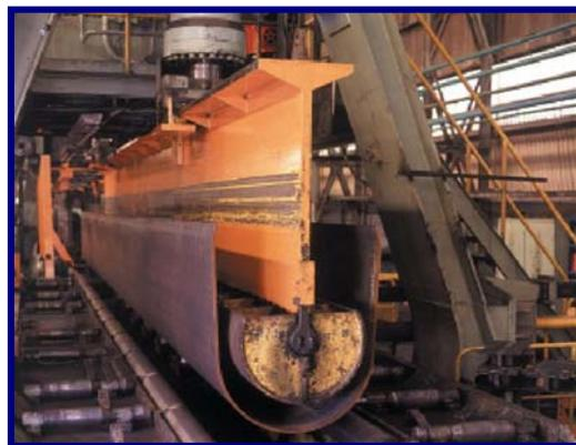
Figura 4: Prensagem da chapa na forma de U
