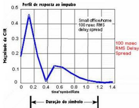
Figura 5.4 - Exemplo de Multipercurso em Ambiente Indoor
