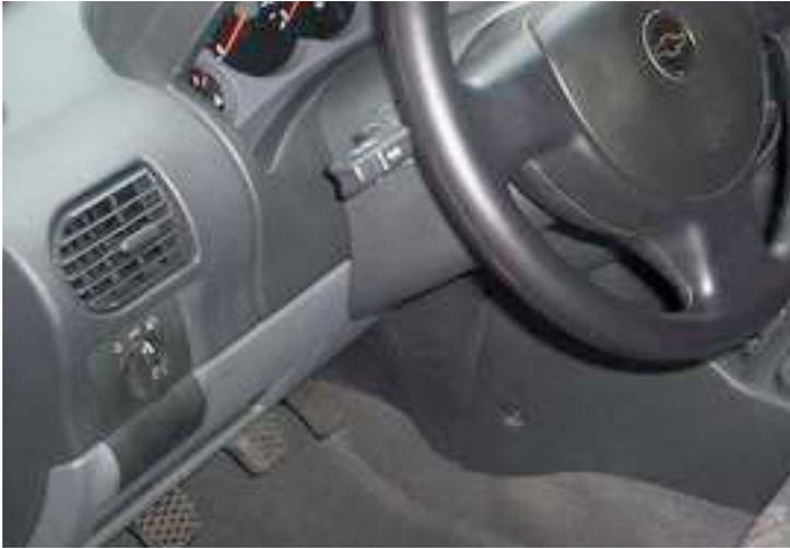
Figura 12 – Comando de acionamento de farol do Novo Corsa.
