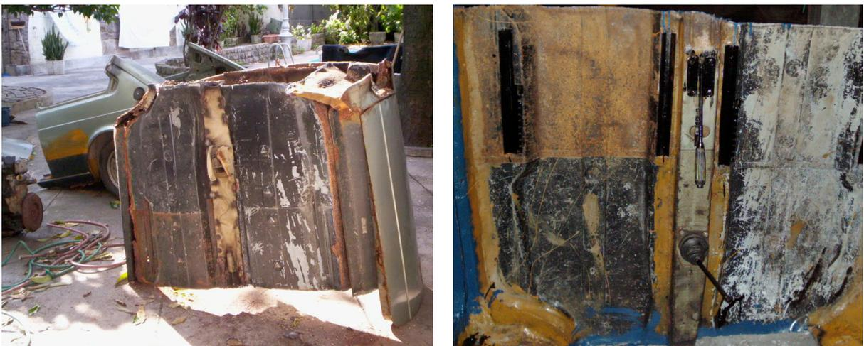
Figura 24 – Retirada de parte do chassi.
