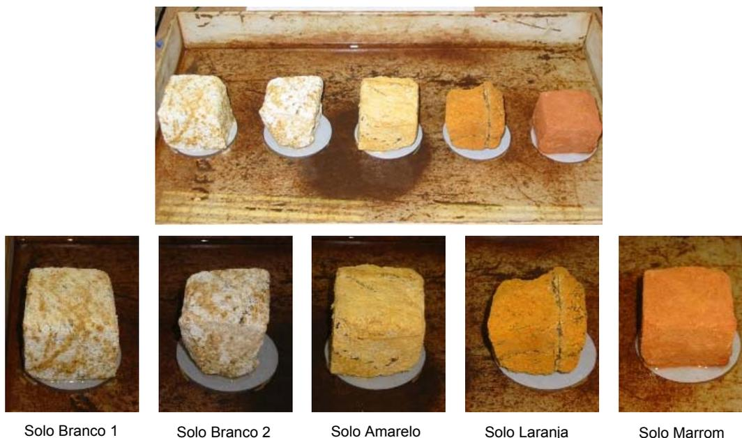
Figura 5.56 – Desagregabilidade - corpos-de-prova colocados sobre pedra porosa no início do ensaio por imersão progressiva - água na altura da base
