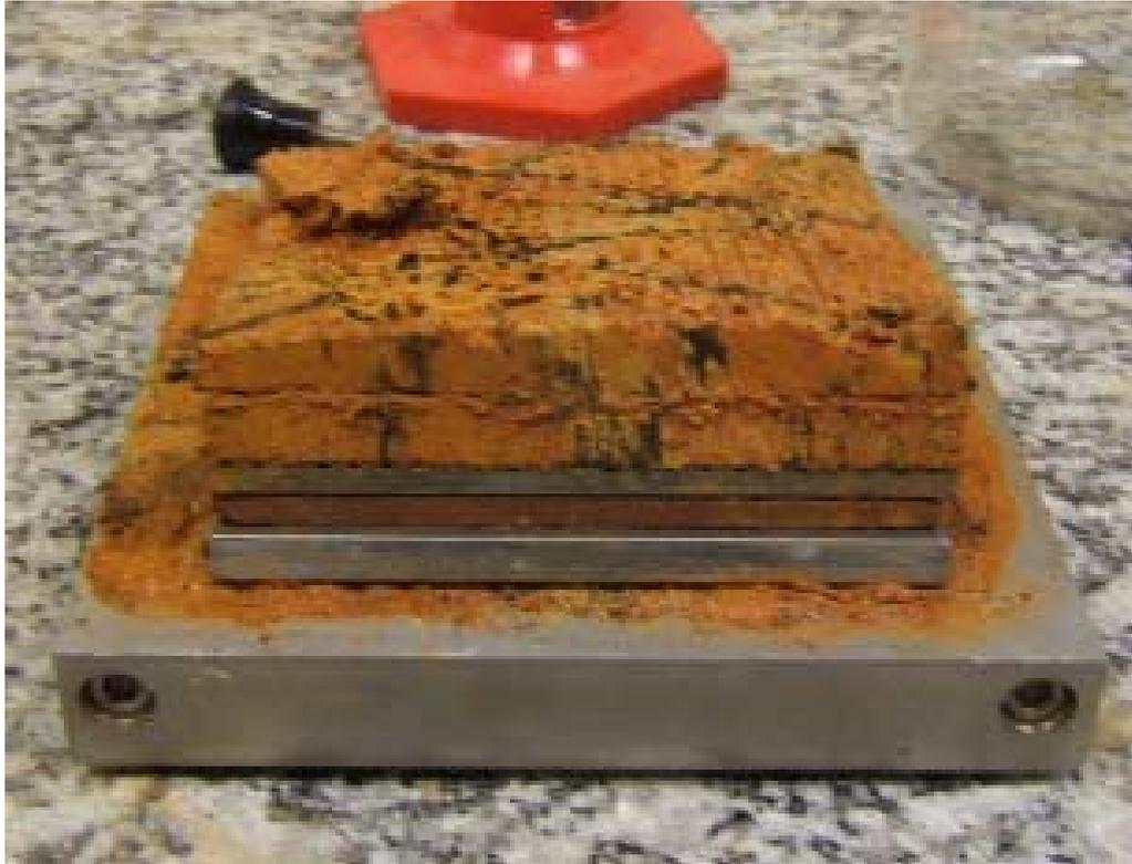
Figura 5.72 – Corpo-de-prova após o cisalhamento
