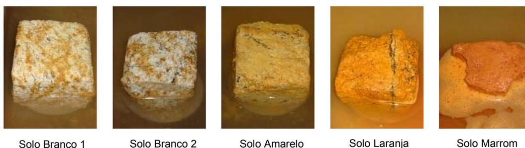
Figura 5.58 – Desagregabilidade - corpos-de-prova após 45 minutos do início do ensaio - nível d'água a  $2/3$  da altura total do corpo
