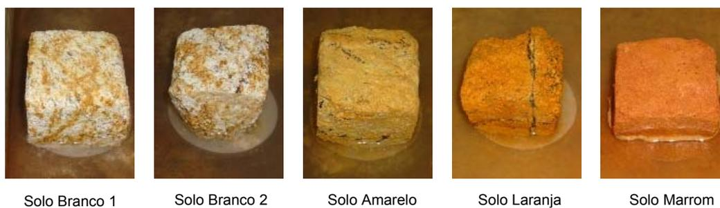
Figura 5.57 – Desagregabilidade - corpos-de-prova após 30 minutos - nível d'água a  $1/3$  da altura total do corpo
