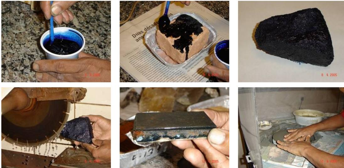
Figura 4.4 – Impregnação do bloco e preparação da lâmina
