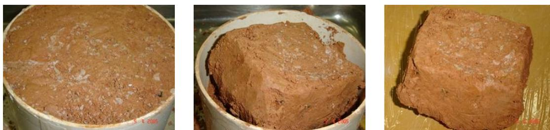
Figura 4.3 – Bloco de solo sendo moldado para impregnação
