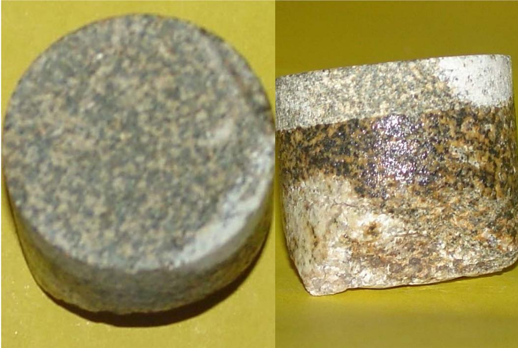
Figura 3.17 – Testemunho de sondagem R 01
