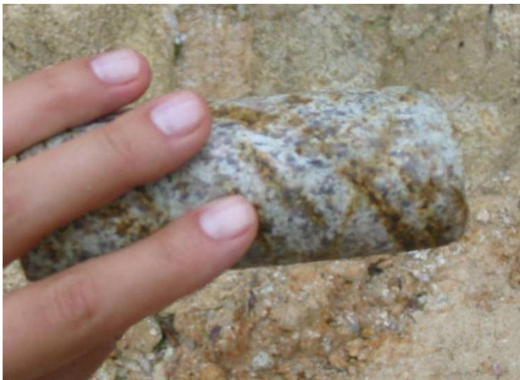
Figura 3.11 – Testemunho de rocha obtido a partir da sondagem
