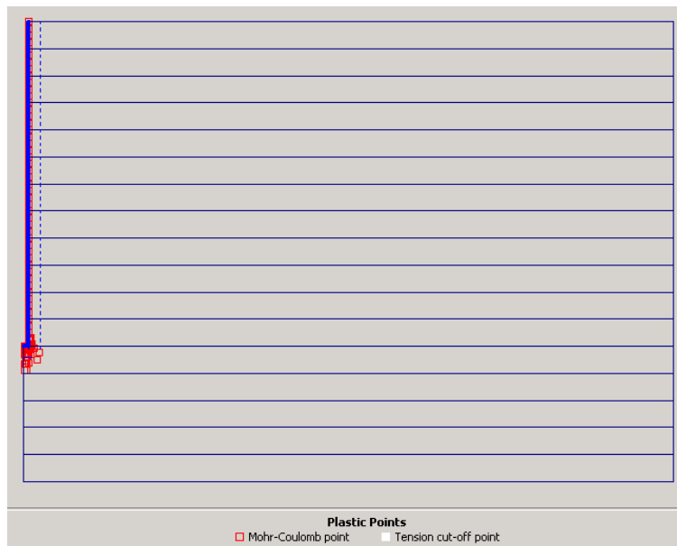
Figura 4.7: Escoamento plástico na base da estaca com carregamento Q_{ult} .
