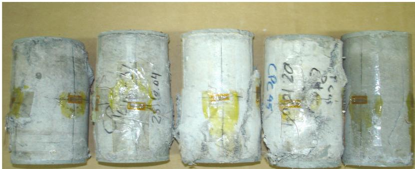
Figura 4.7 – Corpos-de-prova rompidos após ensaios de compressão.
