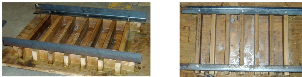
Figura 3.6 – Molde de madeira para 6 vigas, com  $L = 300$  mm e de seção transversal 50 mm x 50 mm.
