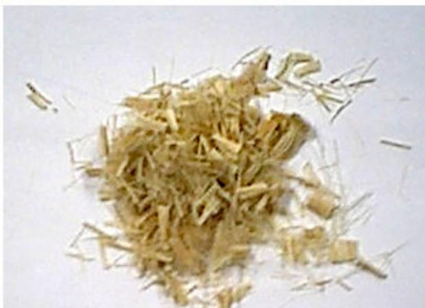
Fibras de Curauá cortadas com 3 cm de comprimento.
