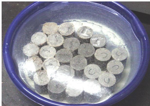
Figura 3.7 – Corpos-de-prova cilíndricos em processo de cura por imersão em água.
