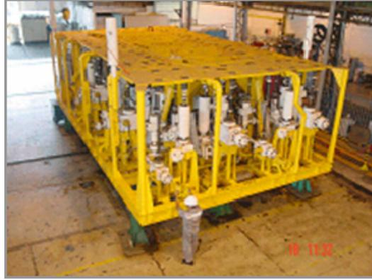
**Sistemas de controle submarinos** – Sistema eletro-hidráulico utilizado nos equipamentos submarinos para viabilizar o controle da superfície da abertura e do fechamento das válvulas e a leitura das informações dos sensores neste equipamentos. Esta estação de controle é normalmente localizada nas plataformas de produção.
