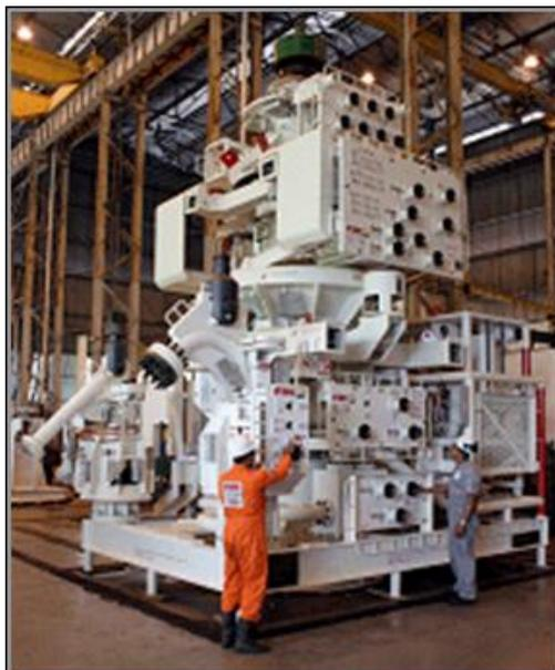
**Manifolds submarinos**—Conjunto de válvulas, sensores e tubulações que servem para coletar a produção de petróleo e gás dos poços e direcioná-las para tubulação única e simplificar o escoamento da produção.
