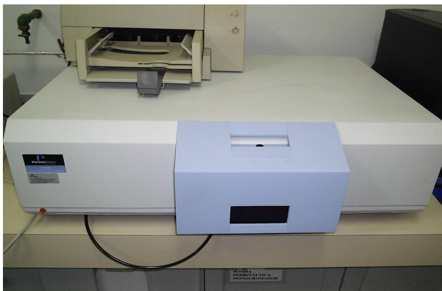
Figura 5. Espectrômetro de luminescência da Perkin Elmer modelo LS-45.
