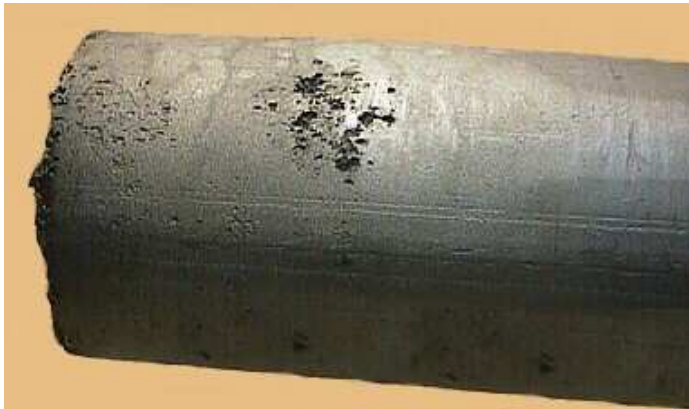
Figura 1.2: Duto com corrosão[9]
