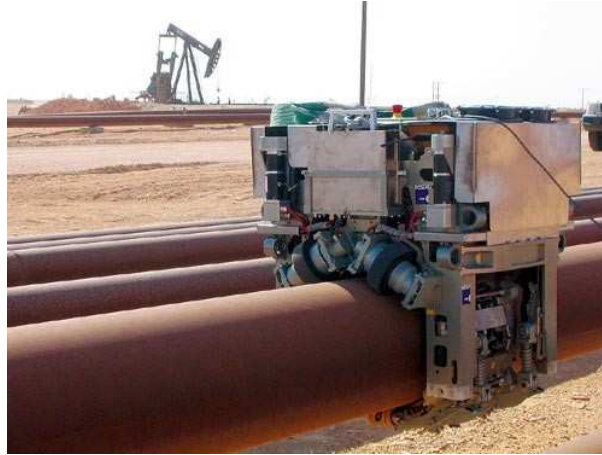
Figura 1.4: Inspetor externo de dutos (IED)[14]
