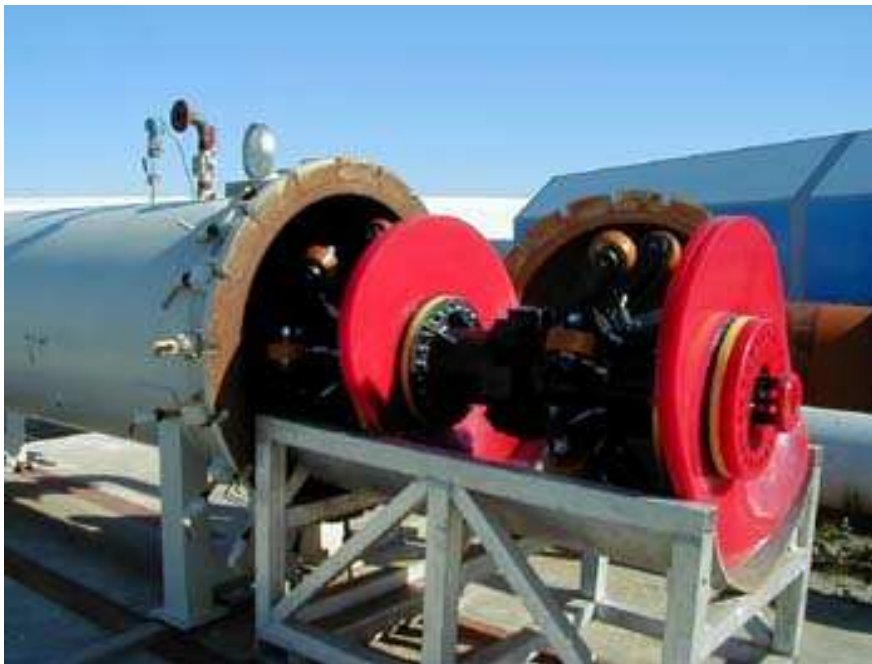
Figura 1.3: PIG sendo inserido em um duto[13]
