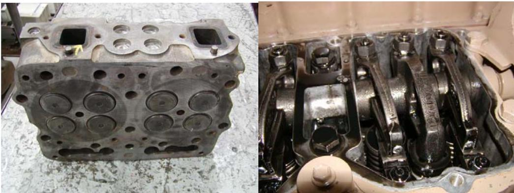
Figura 22: Balancins e válvulas do Cummins NTA855G3.
