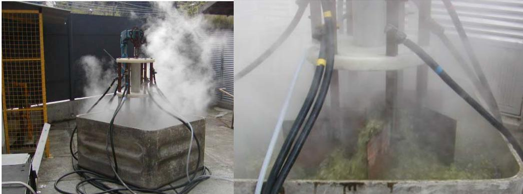
Figura 25: Banco de carga usado na dissipação e ajuste de potência elétrica. As fotos foram tiradas enquanto o sistema dissipava 330 kW.
