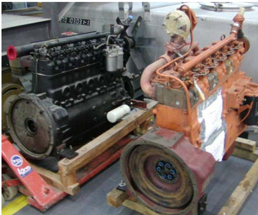
Figura 18: Motores MWM modelos 229-6 (esquerda) e TD229-EC6 (direita).
