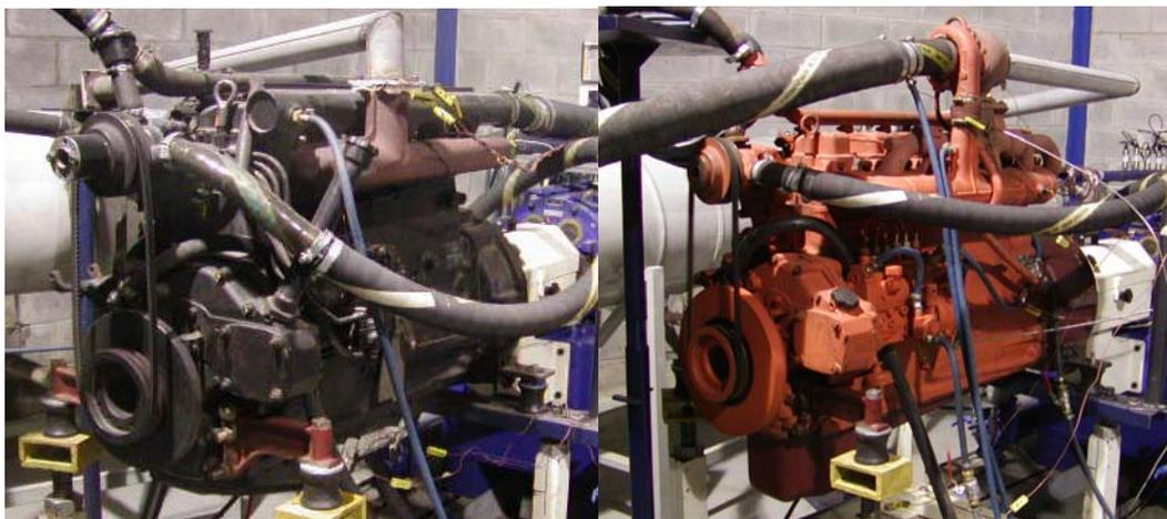
Figura 17: Motores MWM modelos 229-6 (esquerda) e TD229-EC6 (direita).
