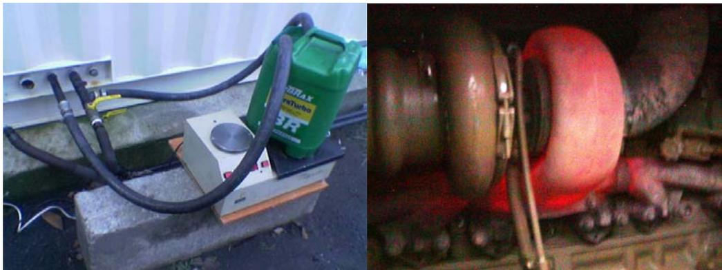
Figura 26: Medida do consumo de Diesel e aspecto de turbina de motor (Cummins NTA855G3) operando sob carga elevada.
