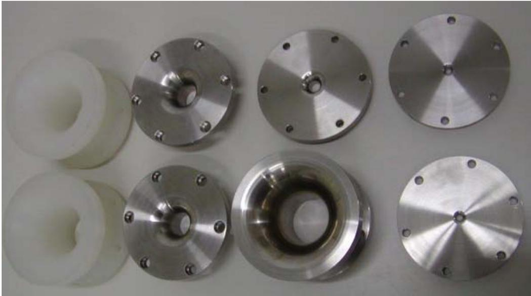
Figura 8: Bocais ASME utilizados nas medidas de consumo de ar e gás natural.
