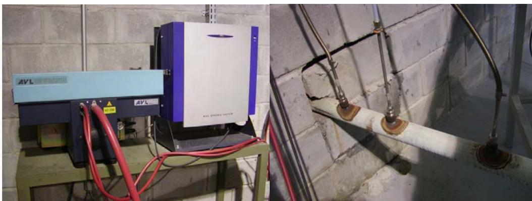
Figura 11: Opacímetro, *Smoke Meter* e pontos de amostragem no escapamento.
