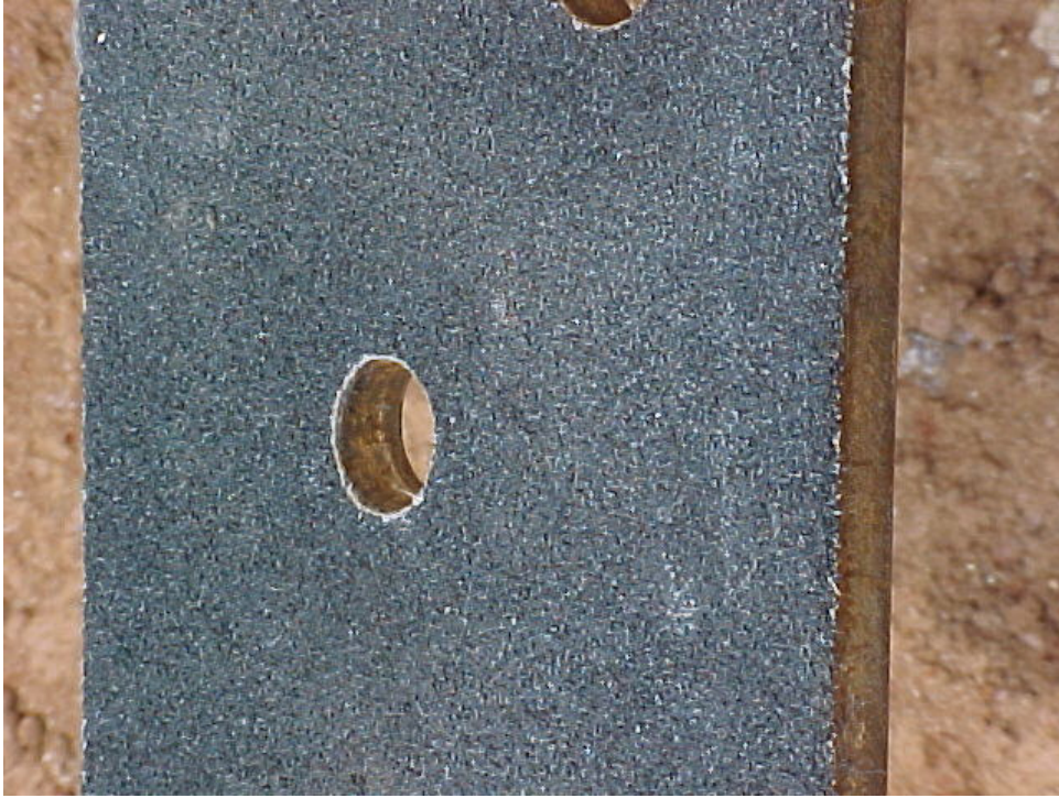
Figura 111 - Detalhe da superfície interna da garra após a colagem da lixa na região de um parafuso passante.
