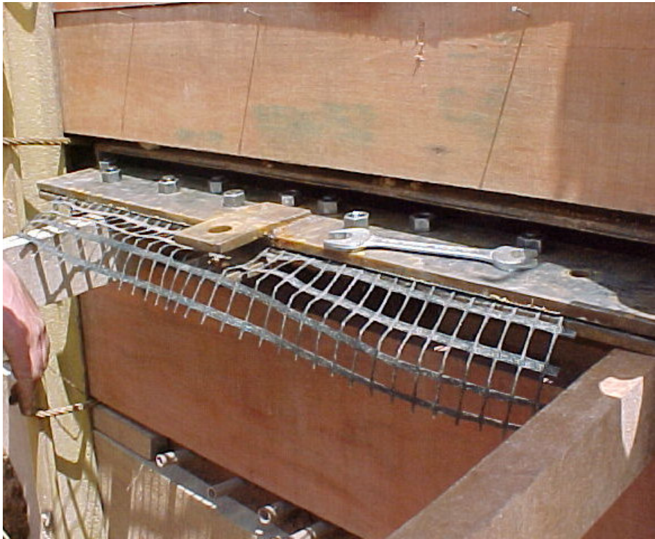
Figura 112 - Detalhe da fixação da geogrelha à garra.
