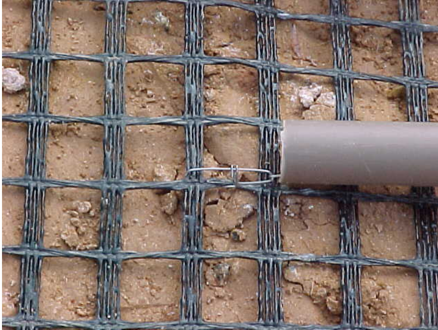
Figura 106 - Detalhe da presilha de fixação do tell-tale na geogrelha.
