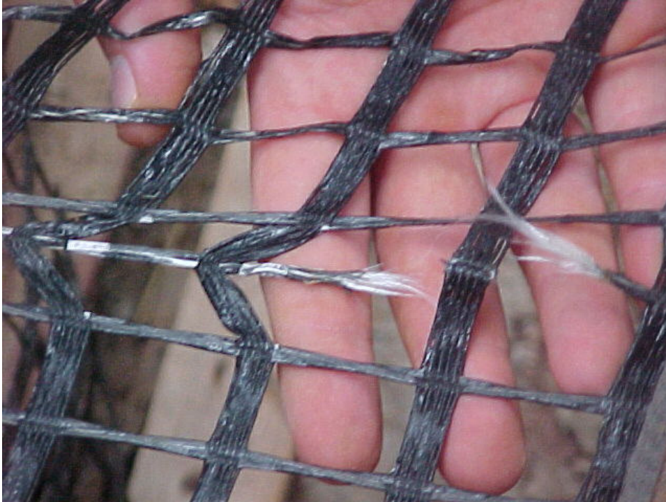
Figura 202 – Ruptura precoce de um elemento longitudinal de geogrelha.
