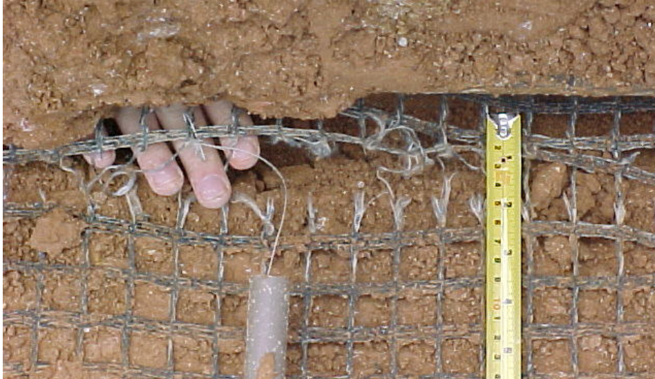
Figura 195 - Geogrelha exumada após ensaio de arrancamento.
