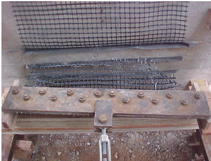
Figura 201 – Ruptura das longarinas da geogrelha ancorada no bloco de concreto no ensaio de tração.
