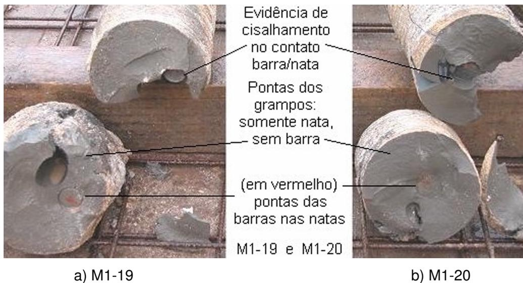
Figura 129 – Evidências do arrancamento no contato barra/nata
