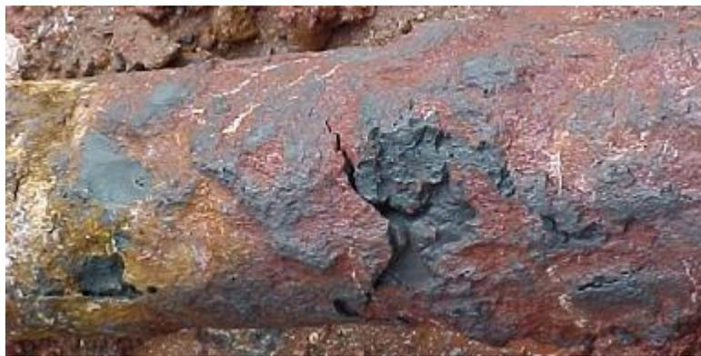
Figura 121 – Aspecto da re-injeção e diâmetro do bulbo para o grampo FV-03
