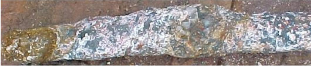
Figura 120 – Aspecto da re-injeção e diâmetro do bulbo para o grampo FV-02
