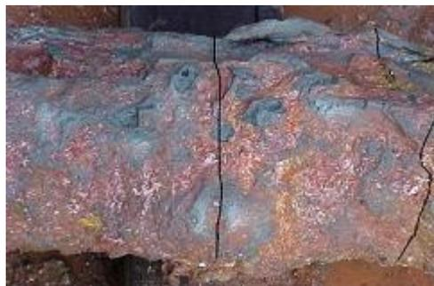
Figura 122 – Fissuras transversais encontradas no grampo exumado FV-03
