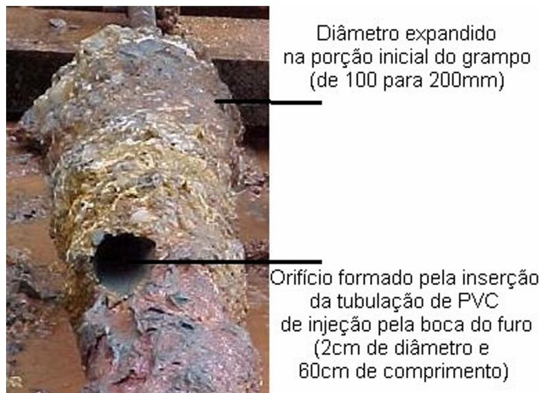
Figura 115 – Aspecto do grampo FV-03 após o ensaio e a exumação
