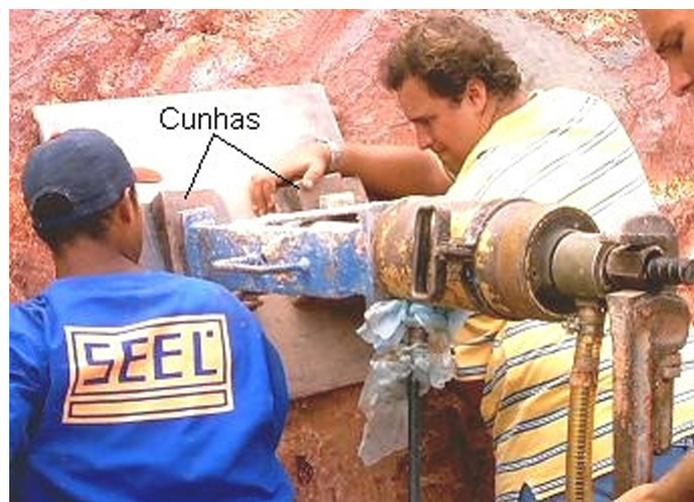
Figura 74 – Utilização de cunhas na montagem do ensaio M1-02A
