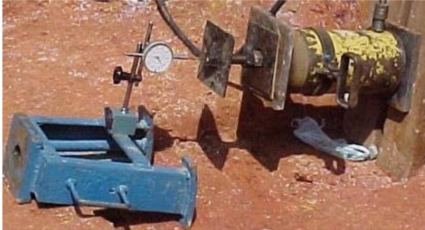
Figura 70 – Sistema de montagem dos ensaios de arrancamento FV-02
