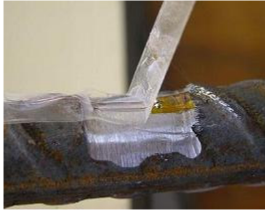
Figura 60 – Retirada da fita adesiva FK-1
