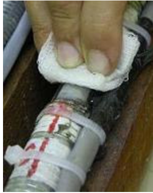
Figura 57 – Limpeza da superfície polida para recebimento do strain gage
