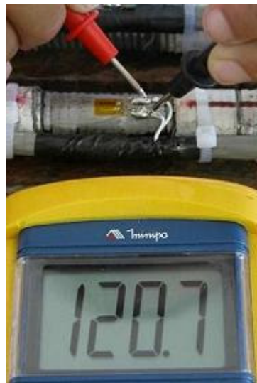
Figura 64 – Verificação do cabeamento do strain gage e da transmissão de sinal
