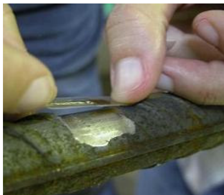
Figura 59 – Colagem da fita adesiva à barra de aço
