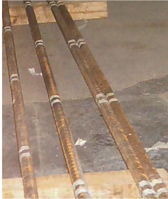
Figura 53 – Marcação da distribuição dos strain gages ao longo da barra
