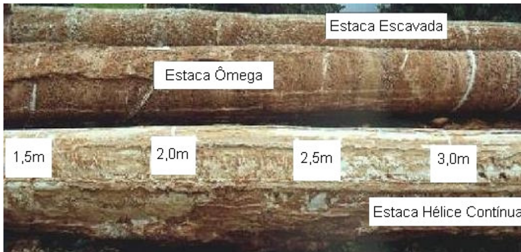
Figura 21 – Bulbos do primeiro trecho da estaca Hélice Contínua (Albuquerque, 2001)
