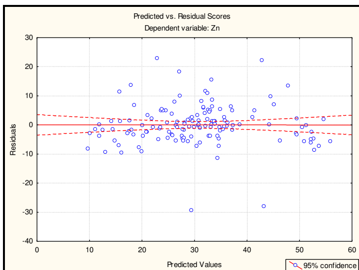
Figura 20 - Gráfico dos valores preditos vs resíduos dos elementos Cu, Ni, Pb, V, Cr e Zn, na realização do modelo de regressão múltipla relativo aos elementos Fe, Al e Mn (variáveis independentes)
