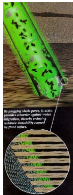
Figura 1-4 – Fluido Selante, representando a capacidade de filtração do fluido de perfuração[20].
