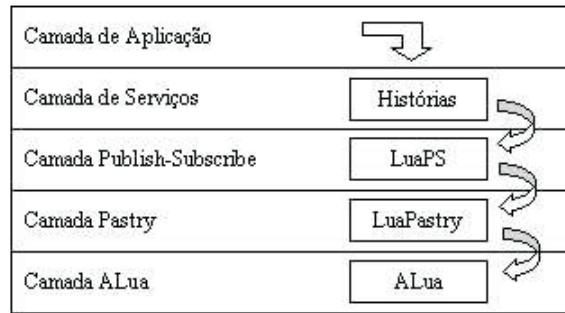
Figura 5.9: Aplicação com um Módulo de Serviço
