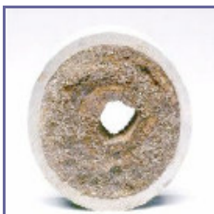
Figura 1.2: Exemplo de uma linha bloqueada por deposição de parafinas (Cortesia do CENPES / Petrobras).
