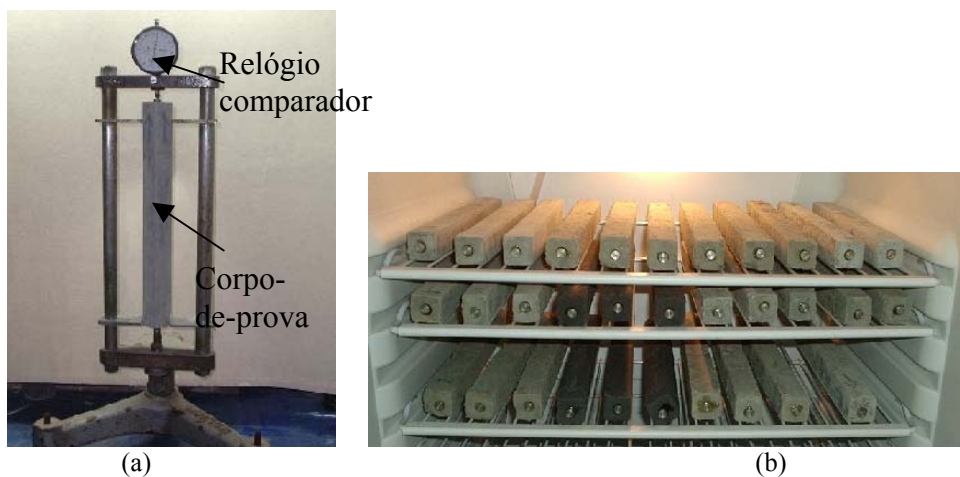
Figura 32: Retratômetro com relógio comparador (a). Corpos-de-prova na câmara climática (b)
