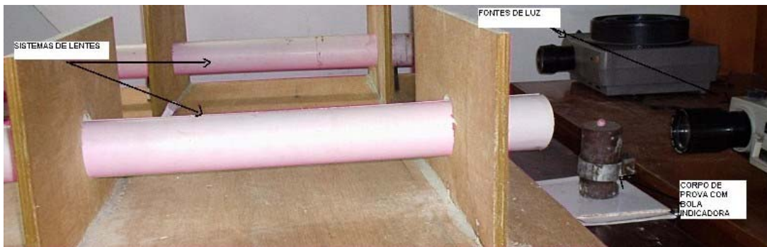
Figura 30: Aparato montado conforme ASTM C 827
