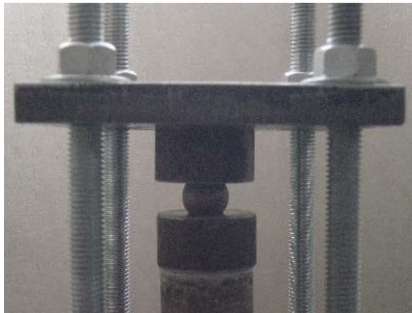
Figura 42: Rótula do pórtico de fluência sob compressão
