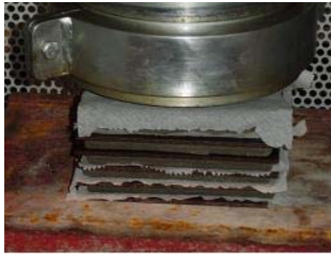
Figura 27: Aplicação de compressão na moldagem das placas
