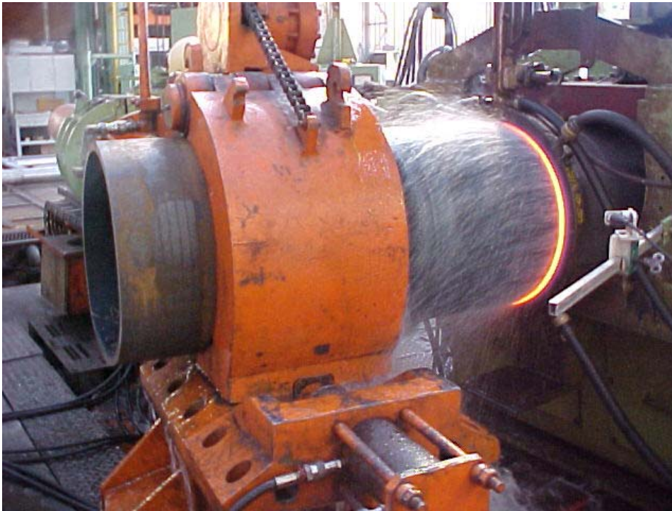
Figura 46- Curvamento por indução realizado na PROTUBO.
