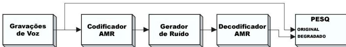
Figura 7: Esquema para a obtenção de valores MOS a partir do PESQ [9].
