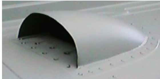
Figura 1-2. Entrada de ar tipo scoop . 1
