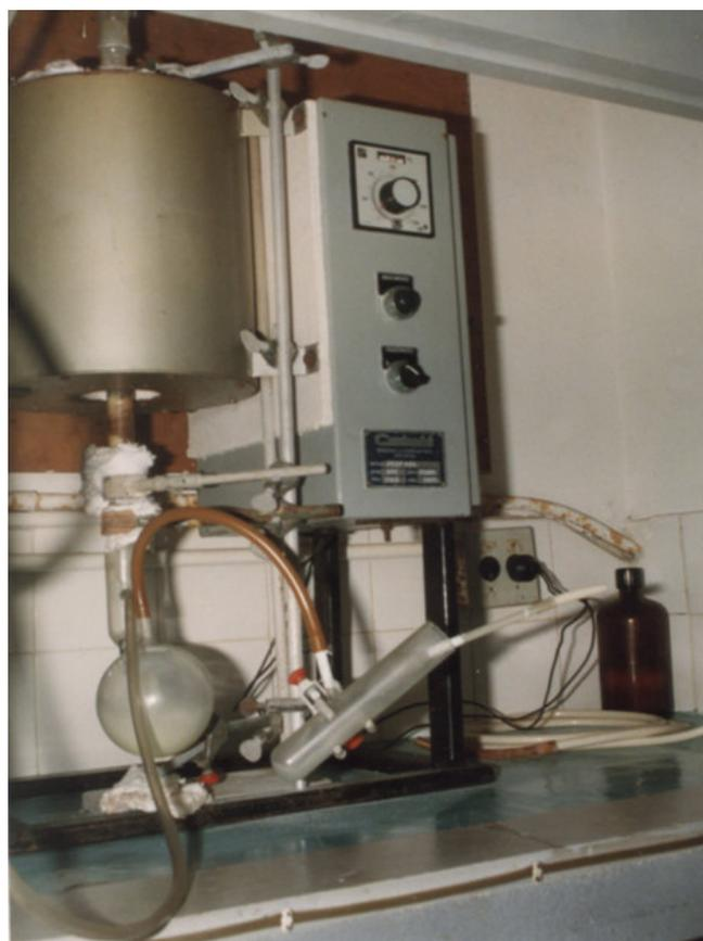
Figura 20 – Unidade experimental de cloração: Foto 2.
