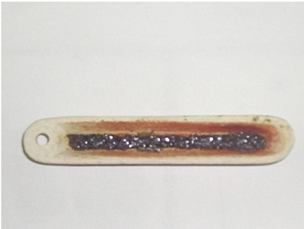
Figura 17 – Material da queima de  $V_2O_5 + C$  em forno tubular com injeção de  $O_2$ .
