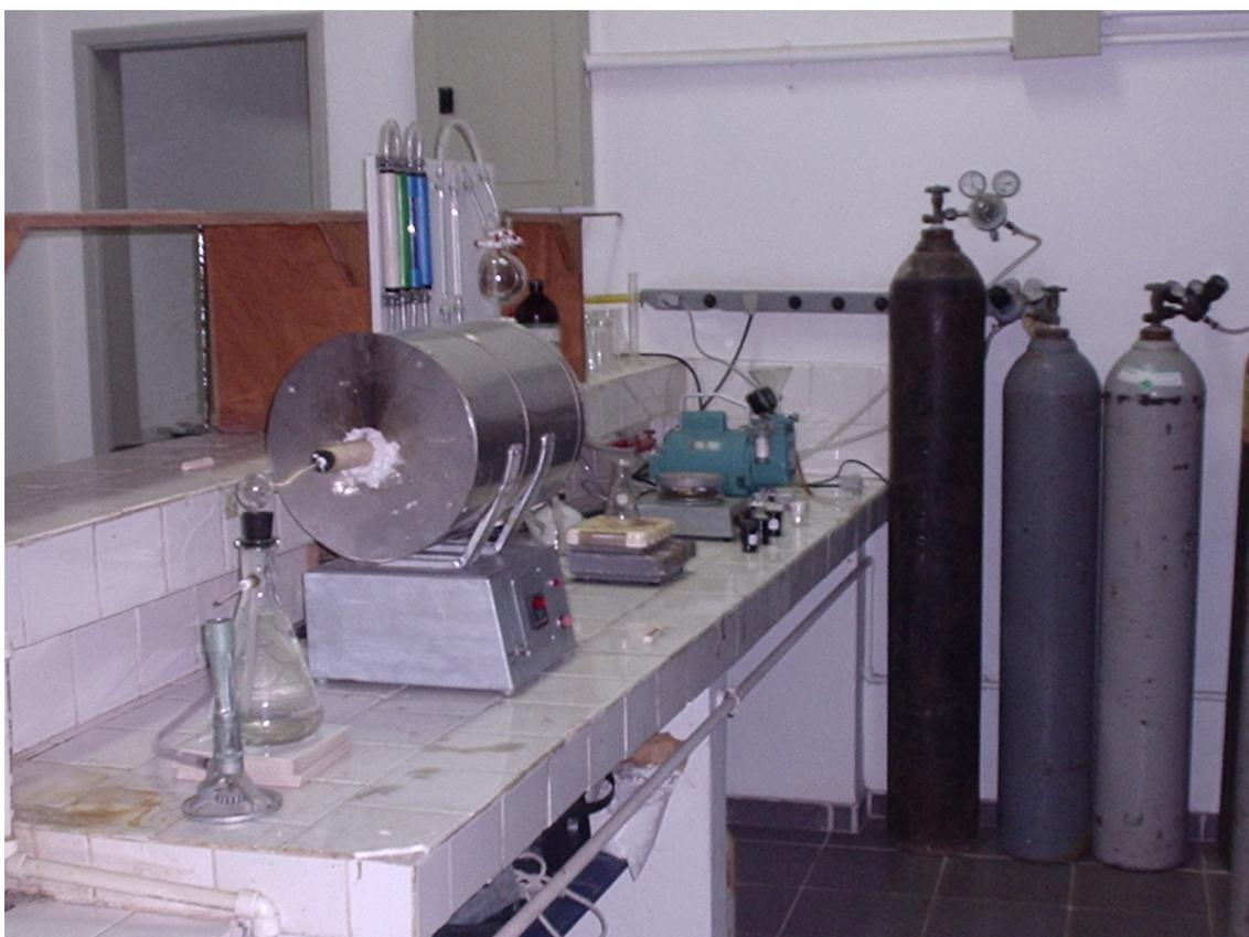
Figura 12 – Forno tubular utilizado na queima das amostras.
