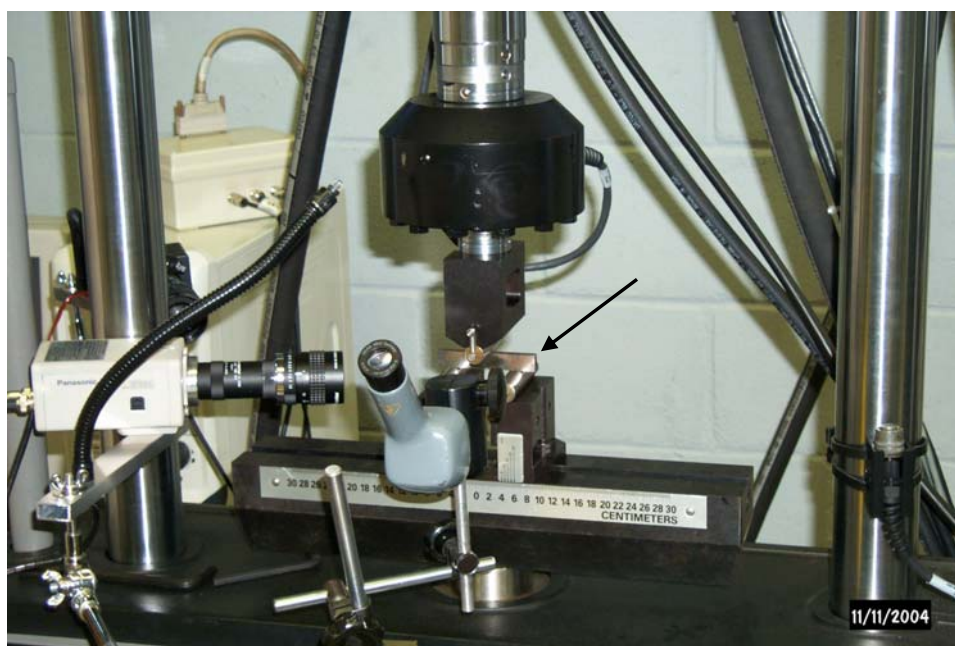
Figura 18- Foto do ensaio de pré-trincamento por fadiga – Cenpes/Petrobras
