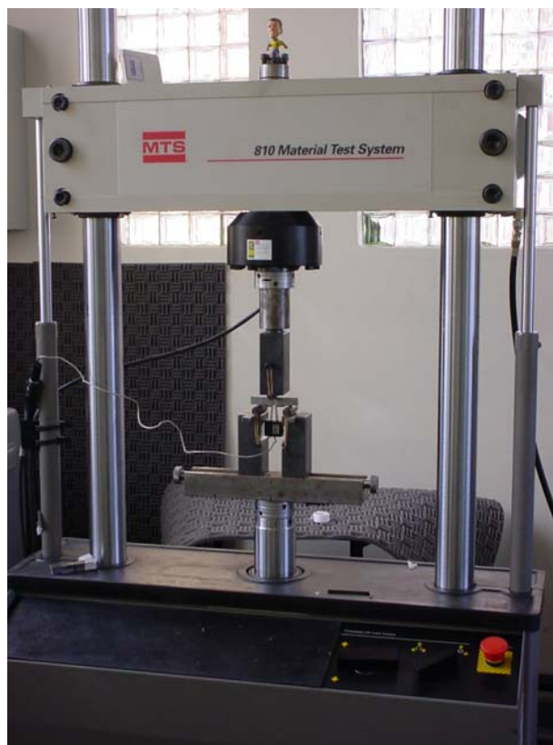
Figura 20 – Vista geral do ensaio de Integral J no equipamento MTS, Lamef/UFRGS
