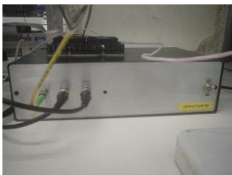
Figura 37 – Refratômetro utilizado para as medições, no qual a fibra óptica do tipo multimodo estava conectada (cabo amarelo).
