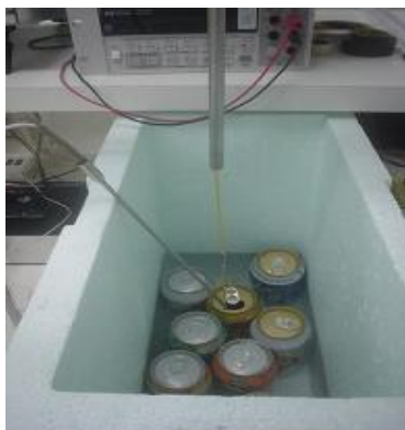
Figura 36 – Banho para acondicionamento das amostras composto de gelo moído e água gelada com temperatura entre 0 e 8°C. Observa-se também a fibra do tipo multimodo e o PT100 utilizados para a realização das medidas devidamente inseridos na bebida (amostra).
