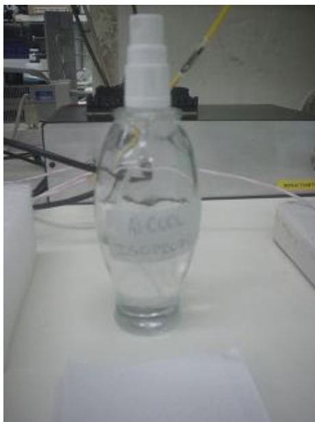
Figura 42 – Álcool isopropílico utilizado para diminuir a formação de espuma na ponta do sensor, o que atrapalharia o desempenho das medições do sensor da fibra óptica do tipo multimodo.
